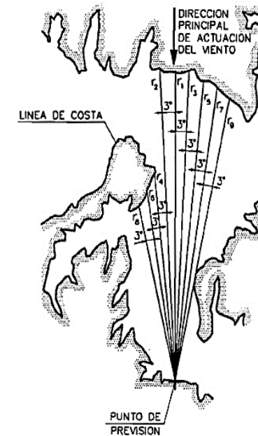
FIGURA II.2.1.1. Procedimiento para el cálculo de la longitud del fetch en zonas costeras o interiores irregulares.
