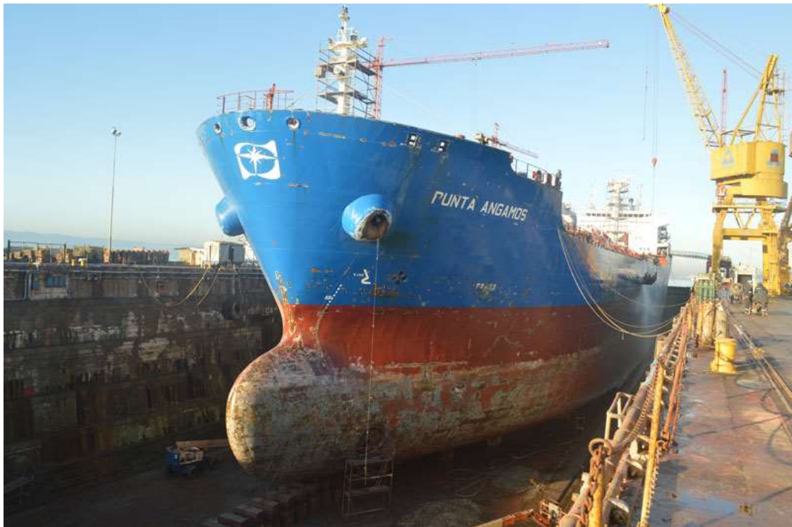
Ilustración 28 Buque con estado de la pintura en deficiente estado
