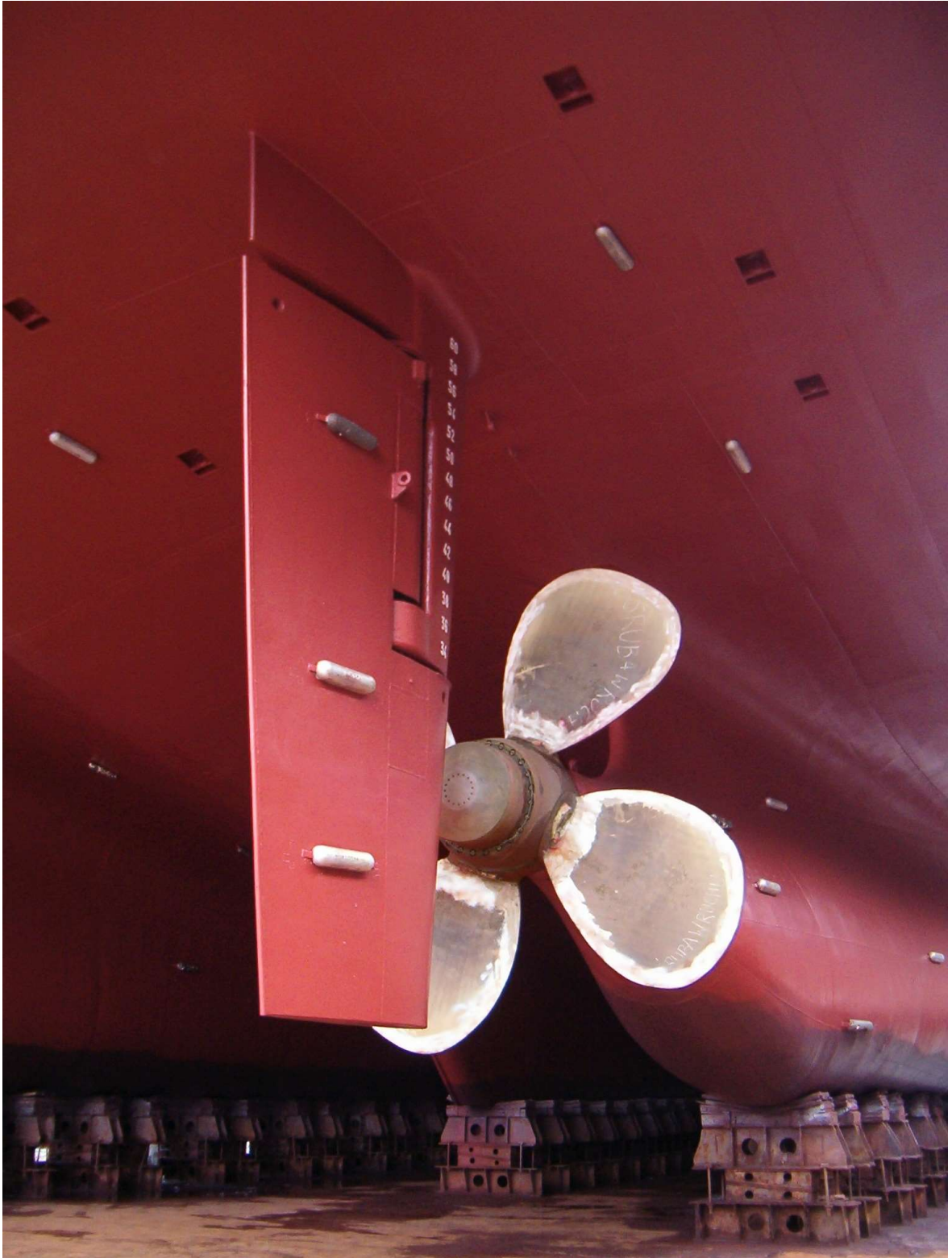
Ilustración 27 Ánodos instalados en el casco del buque
