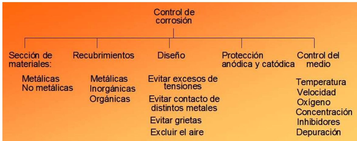
Ilustración 18 Métodos comunes de control de corrosión.
