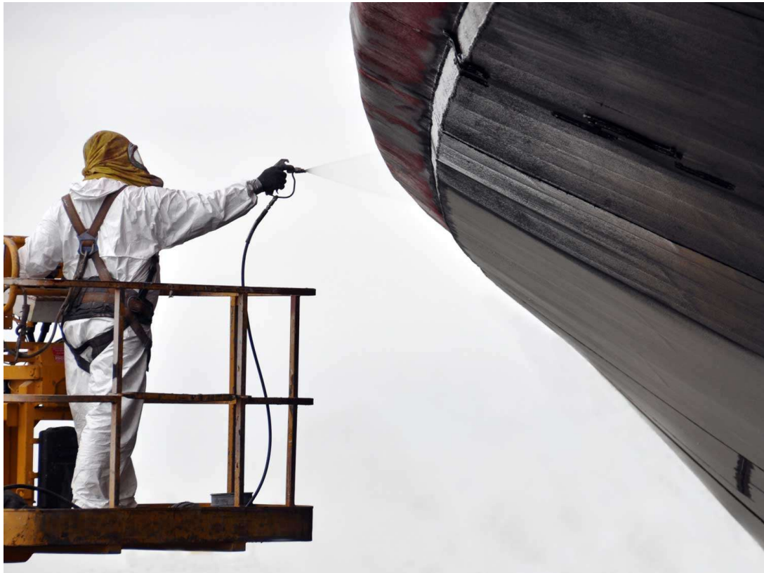
Ilustración 30 Operario tratando el casco del buque
