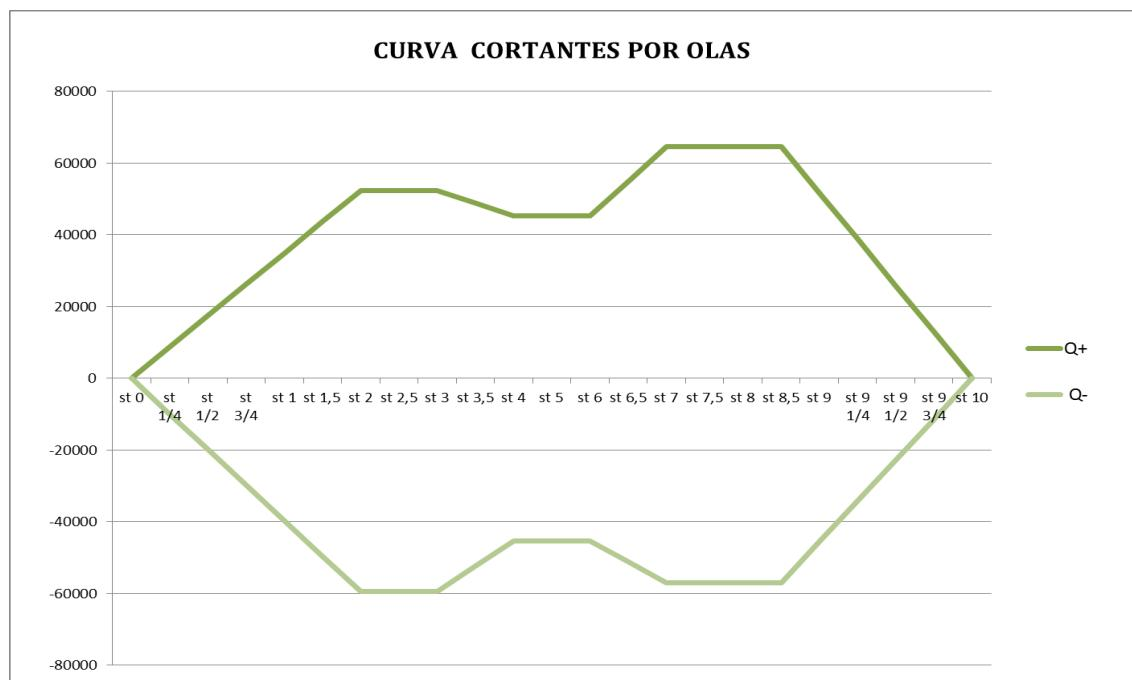
$C_1$ , es el coeficiente de carga de ola que para buques con una eslora comprendida entre 300 y 350 m será de 10,75.
