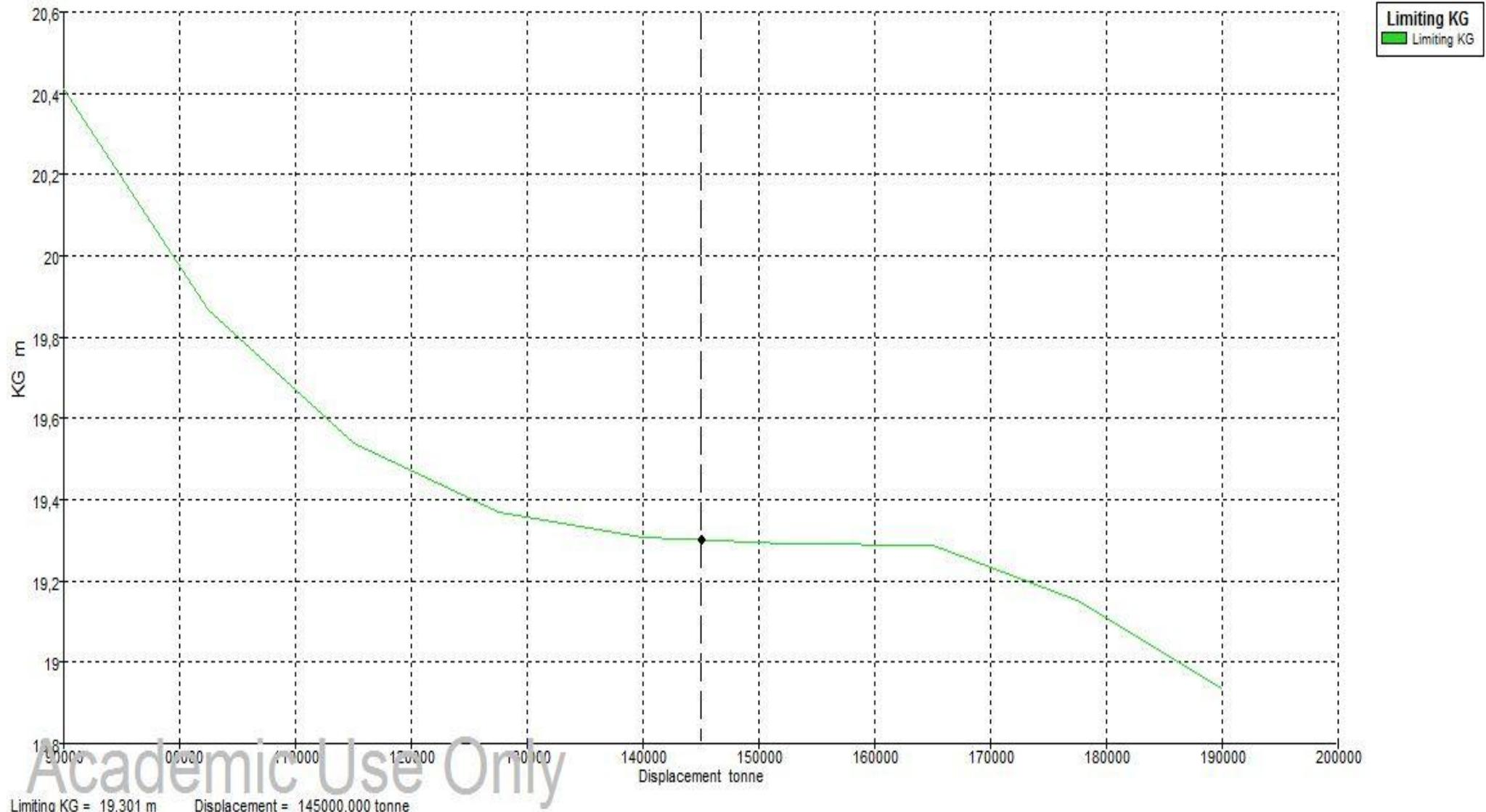
A continuación calculamos el valor del KG para cada una de las condiciones de carga estudiadas anteriormente para ver si se quedan en el rango admisible de valores, es decir, por debajo de la curva de KG máximos:
