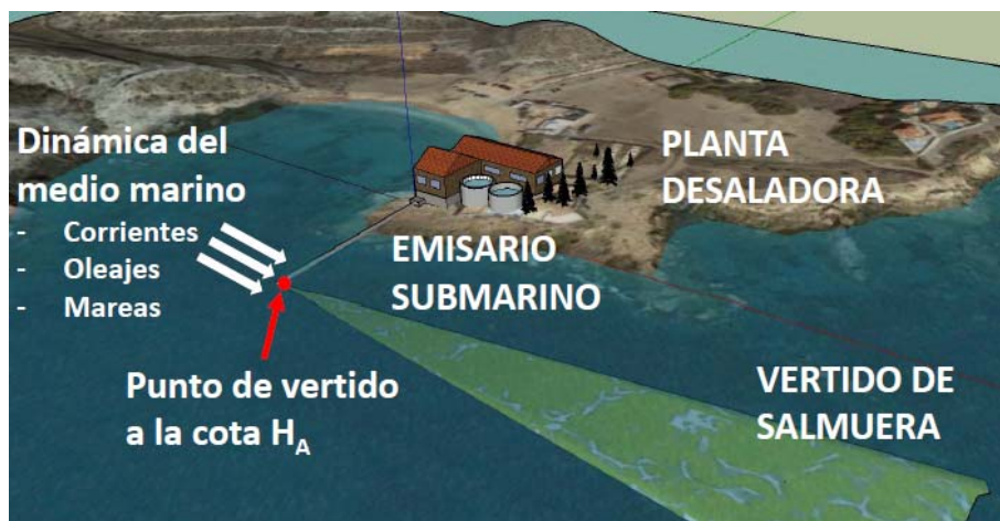
Figura 1.5. Esquema de vertido de salmuera en un medio marino dinámico
