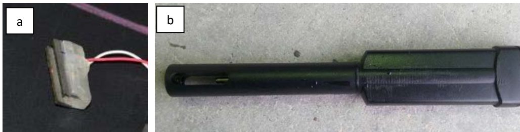
Figura 3.20. Sonda de fabricación propia (a) y sensor comercial Hach Lange, modelo HQ40D multi (b)
