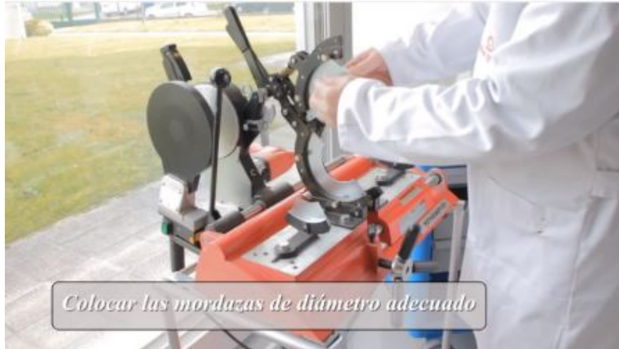
Imagen 8.4 colocación de mordazas
