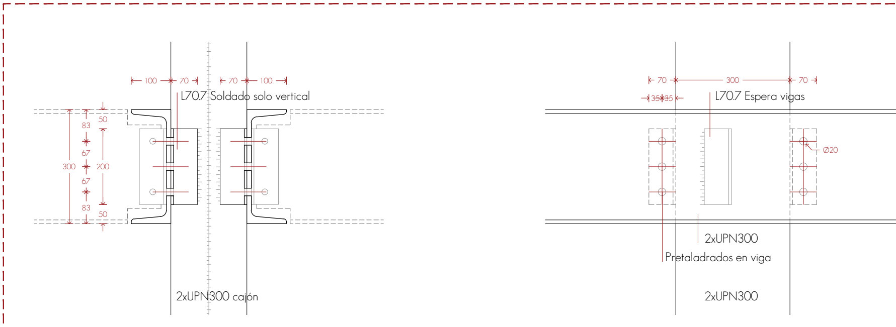
DETALLE 20 ↑ Anclaje tipo 3: vigas 2xUPN300 abiertas con pilares 2xUPN300 cajón l e 1:10
