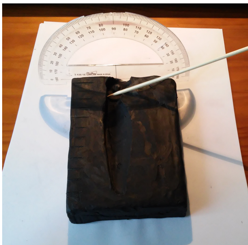
Ilustración 3.5: Procedimiento de medida del ángulo de hélice
