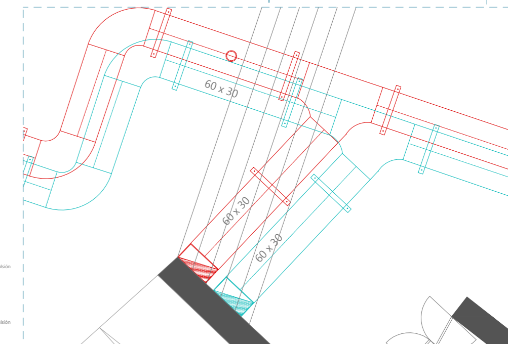
Conductos verticales climatización hacia planta vestuarios.
