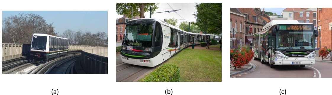
Fig. 4.8. Sistemas de transporte en Lille: VAL (a), LRT (b) y autobús mejorado (c) (Fuente: Recuperado respectivamente de http://strictlysubway.com/europe/lille/ ; http://lillangues.com/lille/decouvrir-lille/ ; http://www.wambrechies.fr/Habiter-a-Wambrechies/Se-deplacer )
