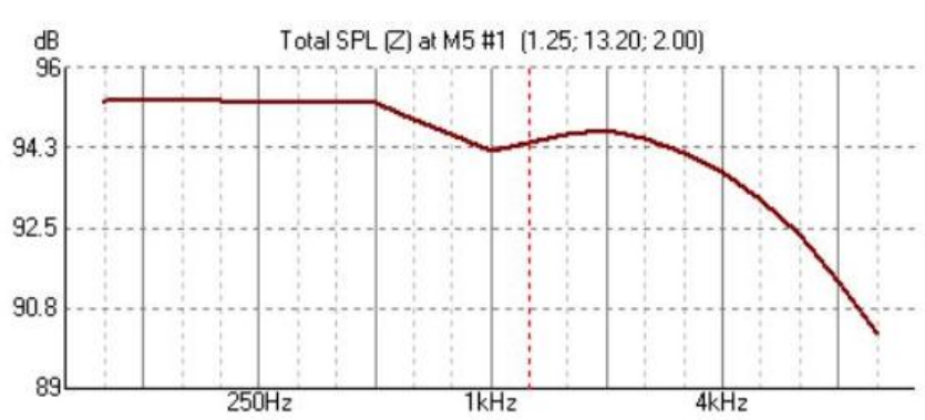
Figura 114. Representación del nivel de presión sonora total con respecto al punto M5 con la fuente sonora S2. Fuente: EASE.
