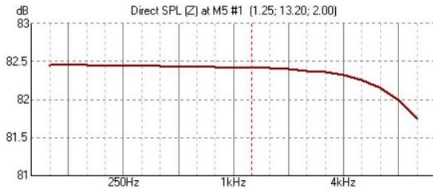
Figura 90. Representación del nivel de presión sonora directo con respecto al punto M5 con la fuente sonora S2. Fuente: EASE.
