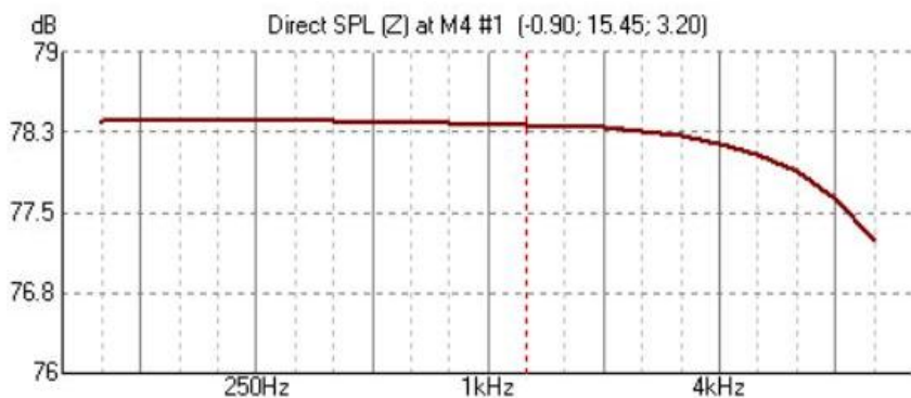
Figura 89. Representación del nivel de presión sonora directo con respecto al punto M4 con la fuente sonora S2. Fuente: EASE.
