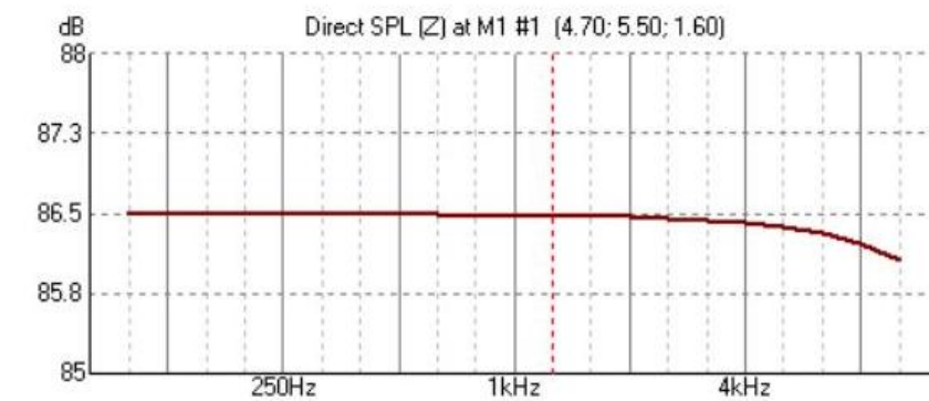
Figura 86. Representación del nivel de presión sonora directo con respecto al punto M1 con la fuente sonora S2. Fuente: EASE.
