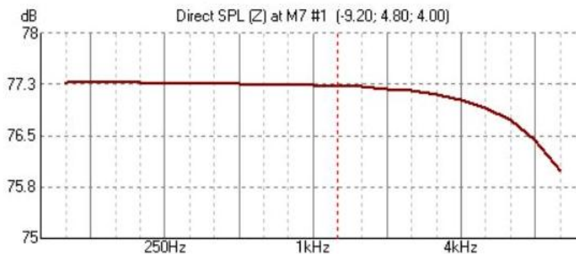
Figura 100. Representación del nivel de presión sonora directo con respecto al punto M7 con la fuente sonora S3. Fuente: EASE.
