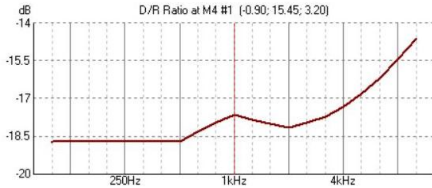
Figura 129. Relación entre campo directo y el reverberante con respecto al punto M4 con la fuente sonora S1. Fuente: EASE.
