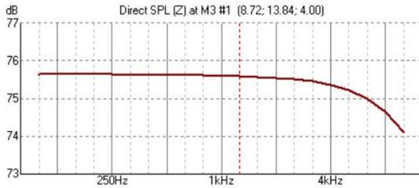
Figura 96. Representación del nivel de presión sonora directo con respecto al punto M3 con la fuente sonora S3. Fuente: EASE.
