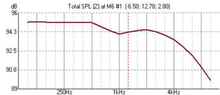
Figura 107. Representación del nivel de presión sonora total con respecto al punto M6 con la fuente sonora S1. Fuente: EASE.
