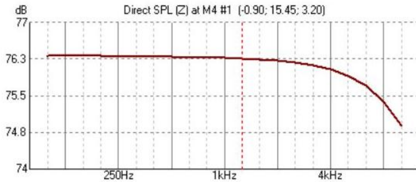
Figura 81. Representación del nivel de presión sonora directo con respecto al punto M4 con la fuente sonora S1. Fuente: EASE.
