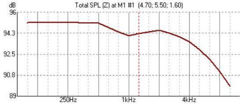
Figura 102. Representación del nivel de presión sonora total con respecto al punto M1 con la fuente sonora S1. Fuente: EASE.
