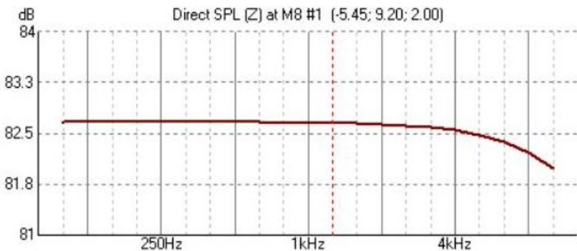
Figura 101. Representación del nivel de presión sonora directo con respecto al punto M8 con la fuente sonora S3. Fuente: EASE.
