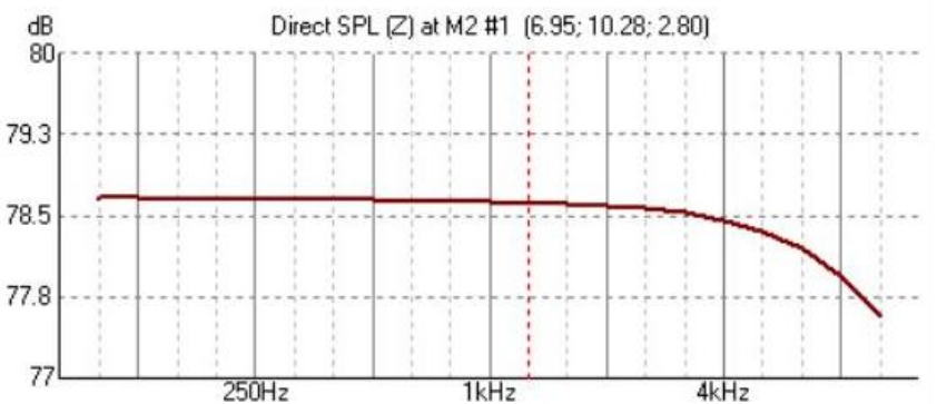
Figura 95. Representación del nivel de presión sonora directo con respecto al punto M2 con la fuente sonora S3. Fuente: EASE.
