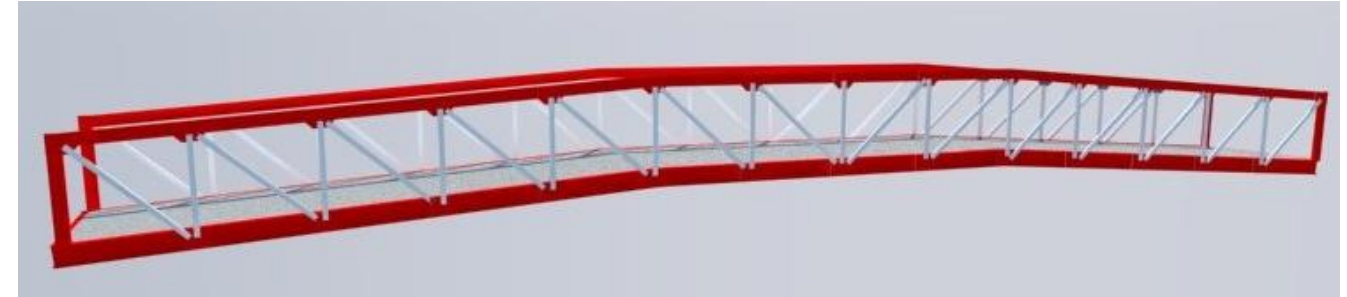
Figura 6. Pasarela metálica peatonal. Fuente: Wikipedia.org
