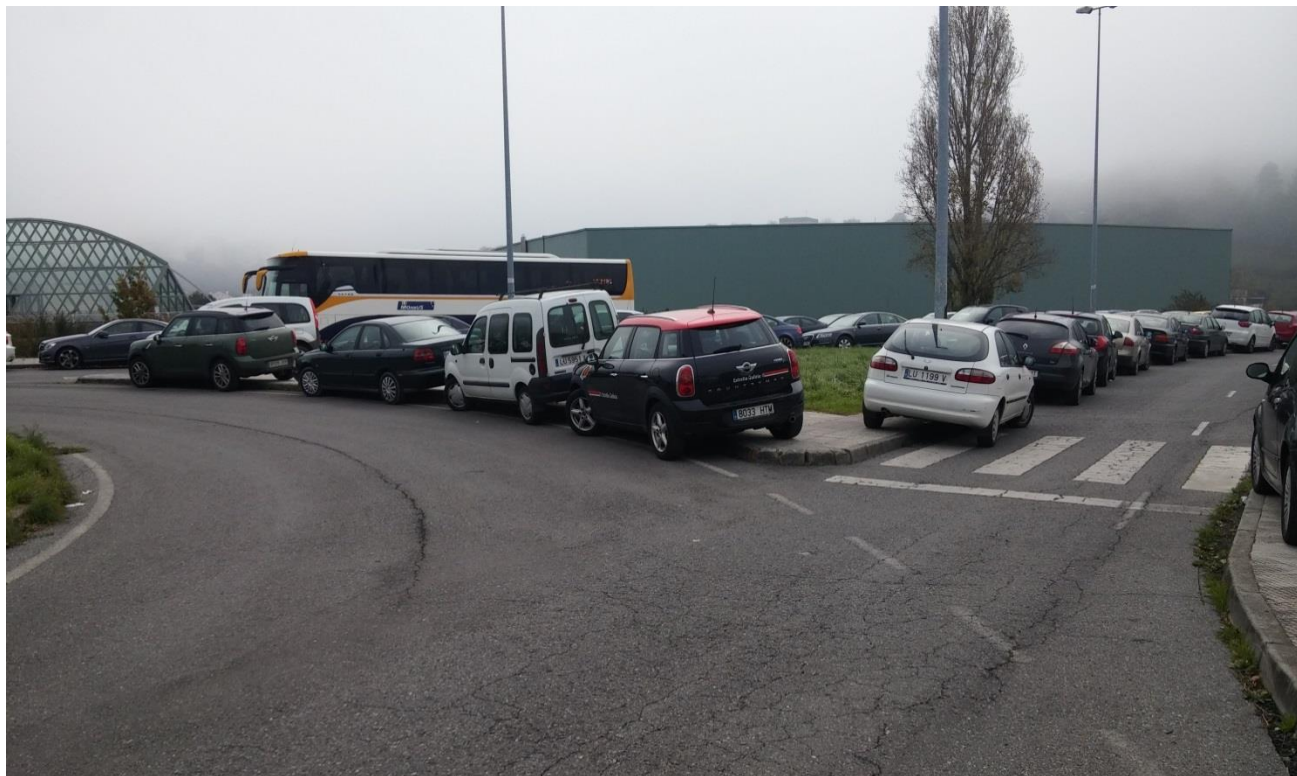
Figura 5. Coches aparcados encima de la acera y en el contorno de la rotonda, disminuyendo en ambos casos el ancho de la calzada de circulación. Fuente: elaboración propia
