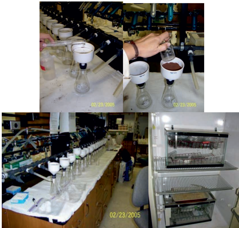
Figura 24. Preparación de las muestras de suelo para la incubación aeróbica en cámara a 25^{\circ}\text{C} en dos acuarios (Repetición 1 y Repetición 2). Experimentación llevada a cabo en el Laboratorio de Suelos de UGA, EE.UU.
