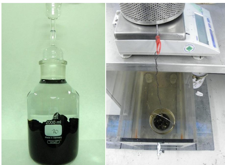
Figura 6-2. Determinación de la densidad máxima (foto izquierda) y aparente (foto derecha) de la mezcla bituminosa.
