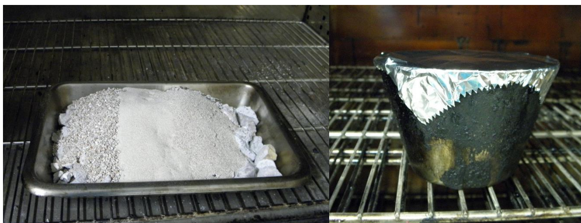
Figura 6-10 Calentamiento del árido (foto izquierda) y cazo con betún (foto derecha).
