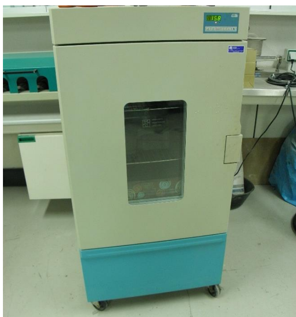
Figura 6-7 Cámara termostaticada empleada para llevar las probetas a la temperatura del ensayo a tracción indirecta.
