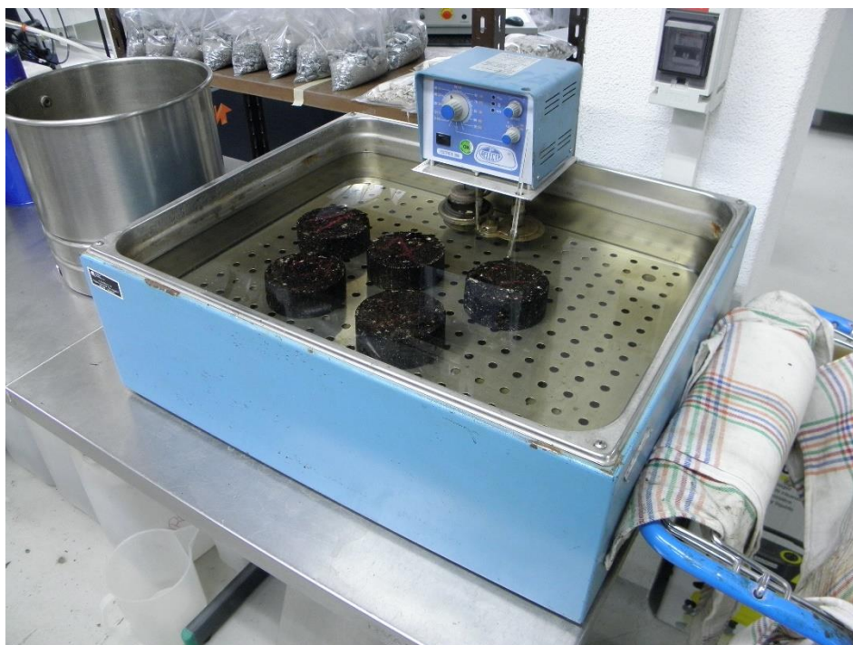
Figura 6-6 Baño de agua a ( 40 \pm 1 ) °C en el que se sumergen las probetas durante un periodo de 68 h a 72 h.
