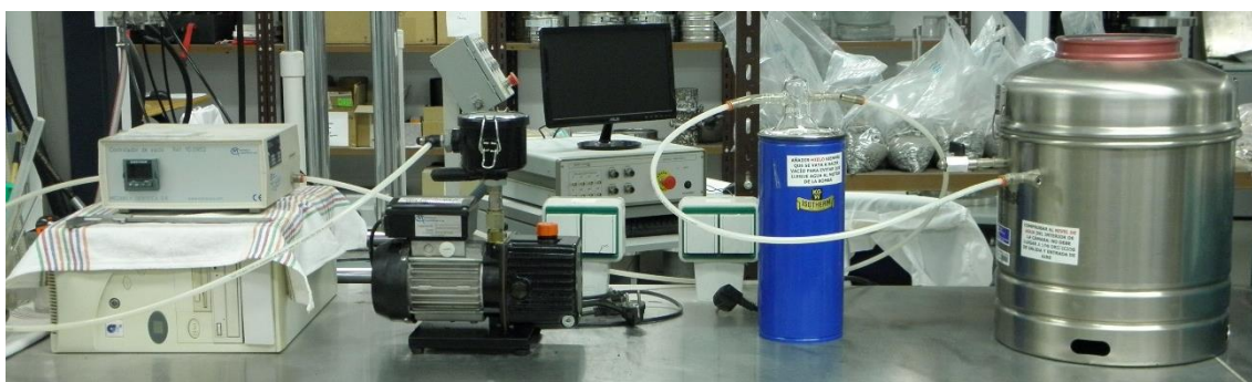
Figura 6-5 Equipos utilizados para aplicar el vacío a las probetas. De izquierda a derecha: controladora, bomba, vaso Dewar y recipiente de vacío.
