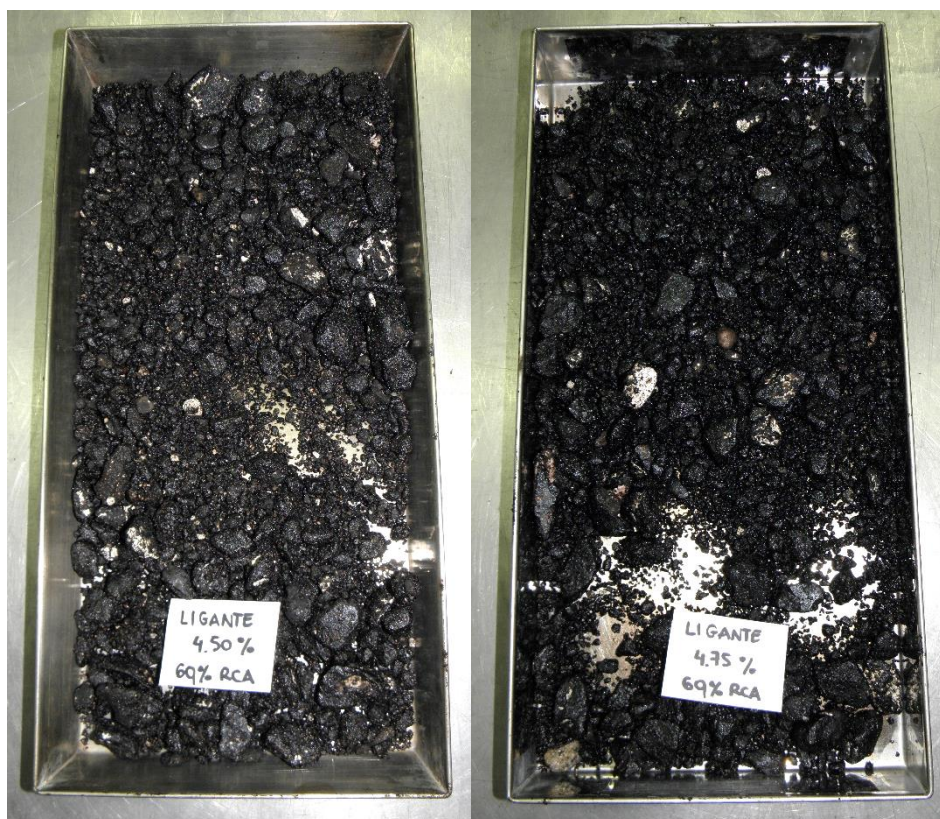
Figura 7-2 Muestras sueltas de 69% AR con 4.5% (foto izquierda) y 4.75% de ligante (foto derecha)
