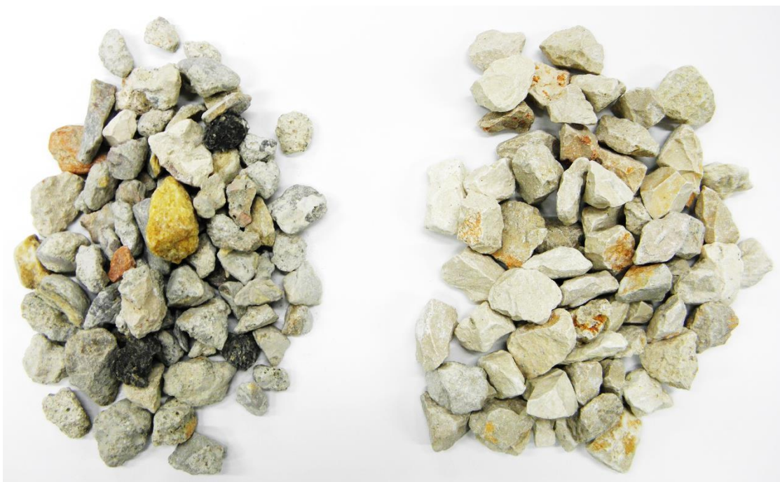
Figura 5-4 Comparación entre el árido reciclado y el árido calizo para la fracción 8/16 mm.
