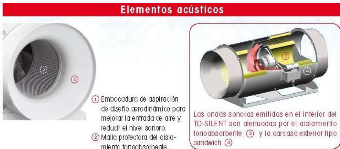
Figura 7. Esquema do ventilador TD-SILENT
