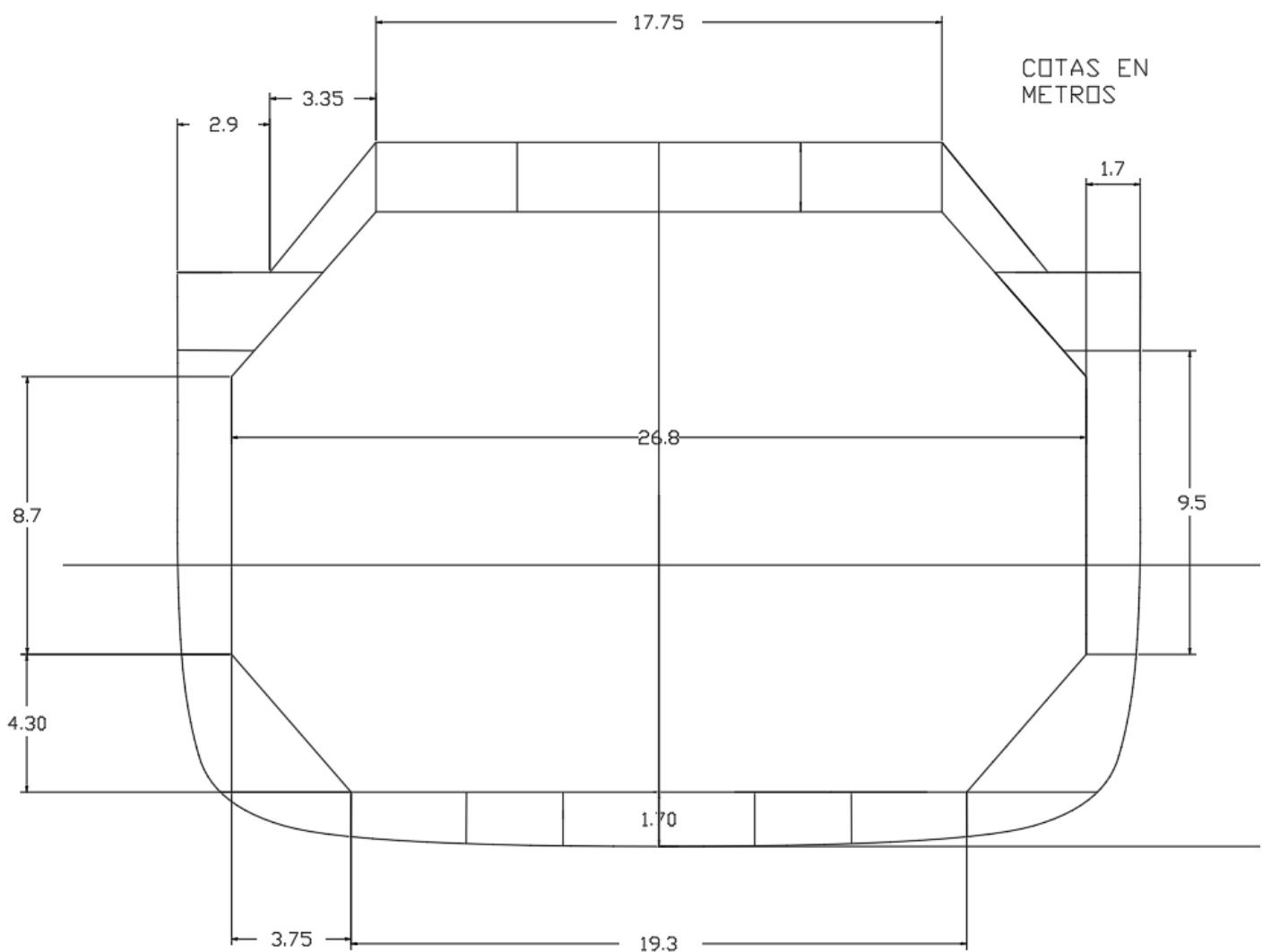
La manga del tanque ha de ser algo más amplia que la considerada para los cálculos de carga útil, ya que la membrana tiene diferentes capas que tienen un espesor determinado, el cual no ocupa la carga útil.
