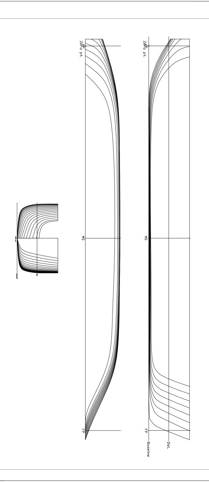
LNG para propósitos de bunkering 35000 m3
