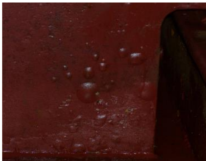
Imagen 5.8. Imagen de las ampollas dispersas por todo el tanque en un 35%.
