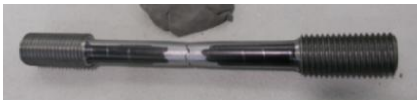
Imagen 3.1. Probeta después del ensayo de tracción.
