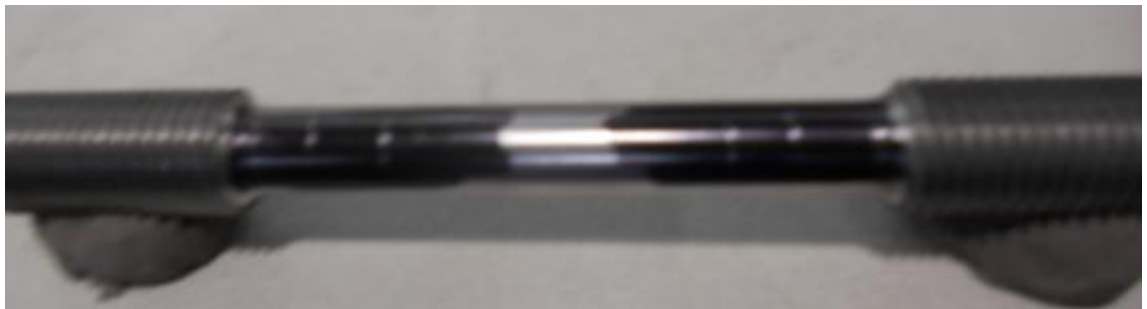
Imagen 2.1. Probeta preparada para el ensayo.
