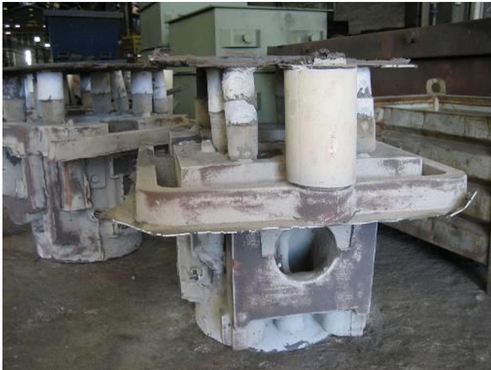
Imagen 1.4. Culata después de desmoldar.
