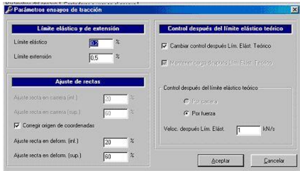
Figura 3.3. Captura de pantalla parámetros de ensayo límite elástico y extensión.
