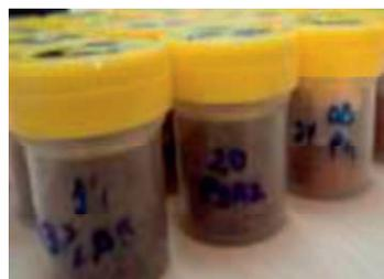
Figura 41: Muestras agregados de suelos para determinación de la superficie específica.
