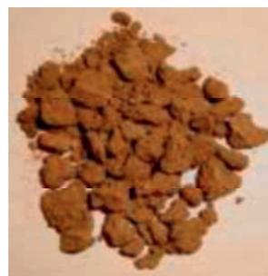
Figura 42: Muestra de agregados utilizados para la determinación de la superficie específica.
