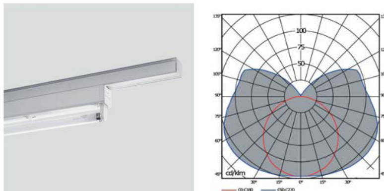
Imagen 4.3.2.1. Luminaria Lledó T5x80W y curva fotométrica
