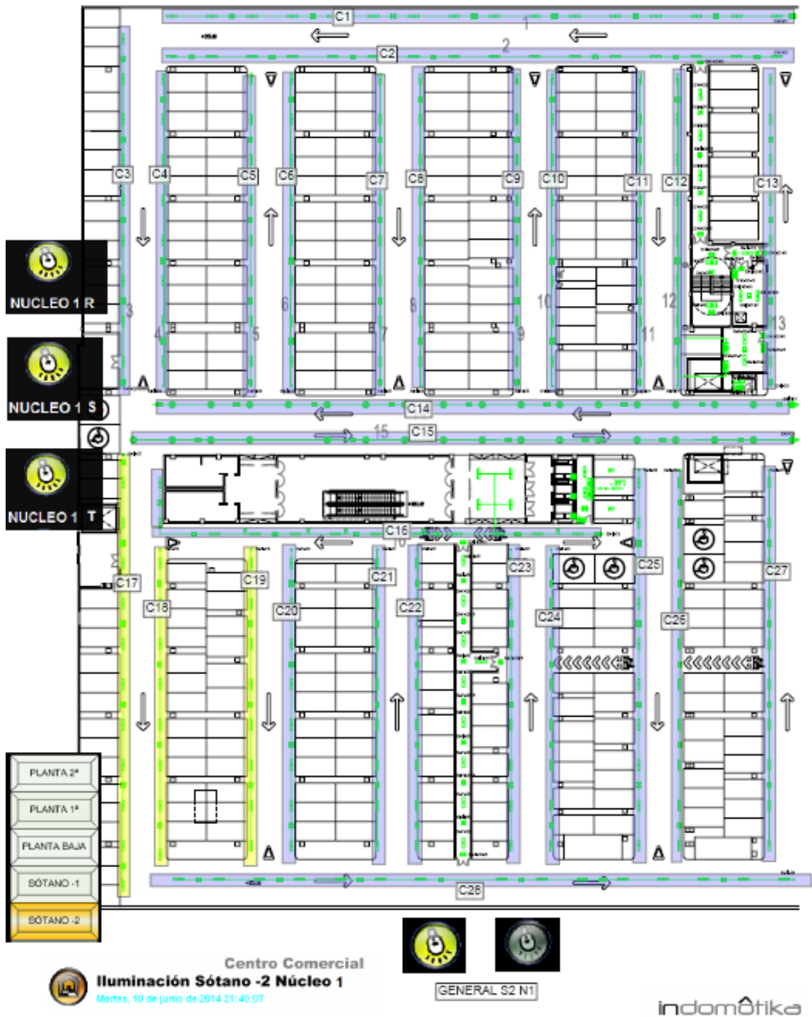
Imagen 5.1.2.1.1 alumbrado general de sótano 2 núcleo 1 reformado
