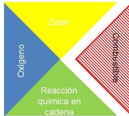
Figura 1.6.5.1 – Eliminación del combustible
