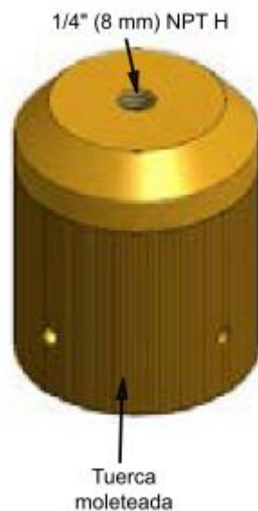
Figura 1.8.2.4.1.1 – Actuador de válvula neumático
