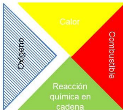
Figura 1.6.5.2 – Sofocación del incendio
