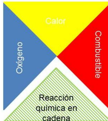
Figura 1.6.5.4 – Inhibición del incendio
