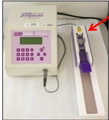
Figura 10. Insitu Porator . En la imagen se muestra el Insitu Porator con una cámara de 8 pocillos lista para electroporar (flecha roja).
