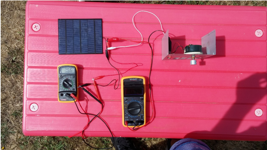
Figura 8.3.2.6- Montaje real medición valores I-V
