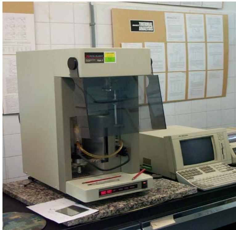
Figura 3.2.2.2.1- Sistema de Análisis Térmico TGA 7
