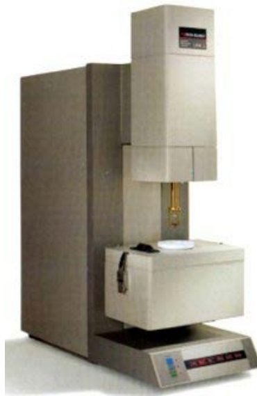
Figura 2.3.5.1.1 – Analizador dinamométrico Perkin Elmer DMA 7.
