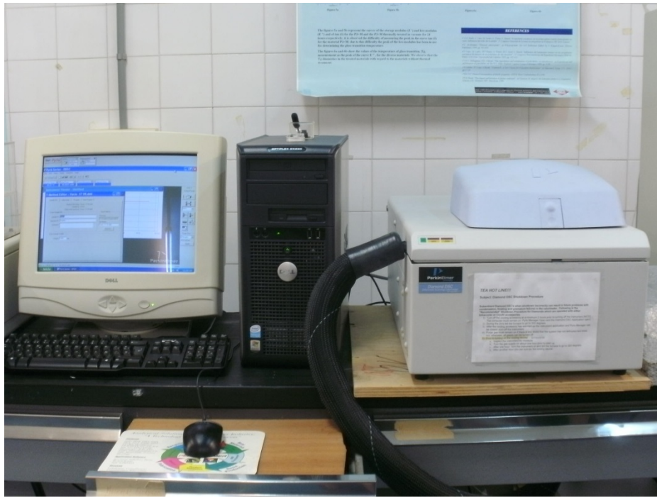
Figura 3.2.2.1.1.1 – DSC DIAMOND de Perkin - Elmer
