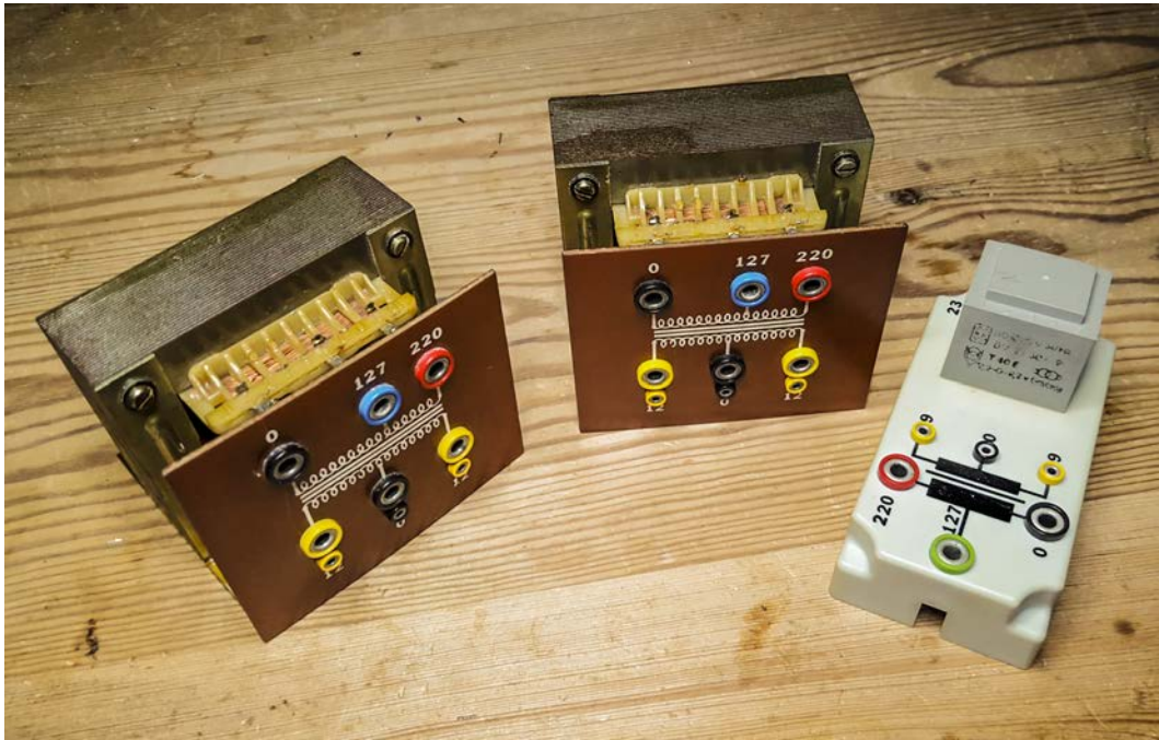
Figura 11.1.1 – Transformadores del laboratorio
