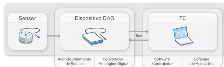
Figura 5.2.1 - Proceso de transmisión de datos en DAQ
