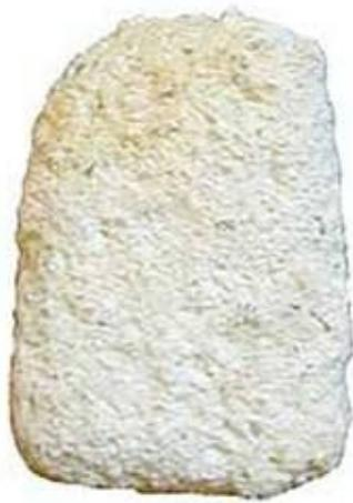
Fig.52.- Granito fuertemente alterado por caolinización.
