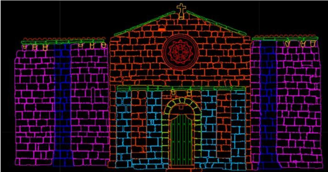
Fig. 38. – Trazado en Autocad por capas de la fachada oeste.
