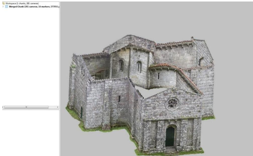
Fig. 30. – Modelo completamente texturizado. Imagen propia, captura de pantalla del proceso de trabajo con Agisoft Photoscan.
