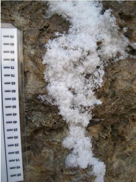
Fig.53.- Detalle de eflorescencias en rocas causadas por la cristalización de sales. Imagen extraída de la página web [https://www.flickr.com/photos/banco\\_imagen\\_es\\_geologicas/5019852815/in/photostream/](https://www.flickr.com/photos/banco_imagen_es_geologicas/5019852815/in/photostream/)
