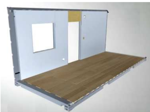
Colocación de las placas de yeso. Fuente: Contenhouse
