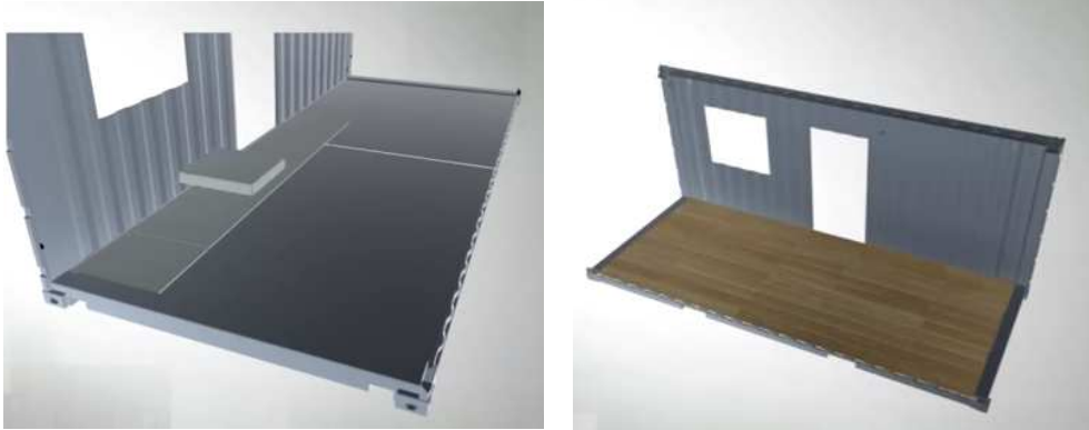
Colocación del suelo. Fuente: Contenhouse
