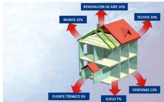
Figura 16 Pérdida de energía a través de la envolvente. (Fuente: Aislamiento de fachadas 2015. Isover)
