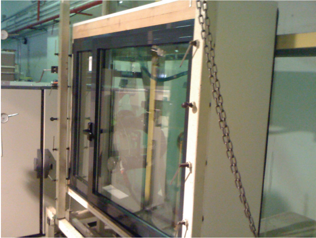
Figura 3.2-1. Vista de la cara no expuesta de una carpintería colocada en el banco de pruebas.
