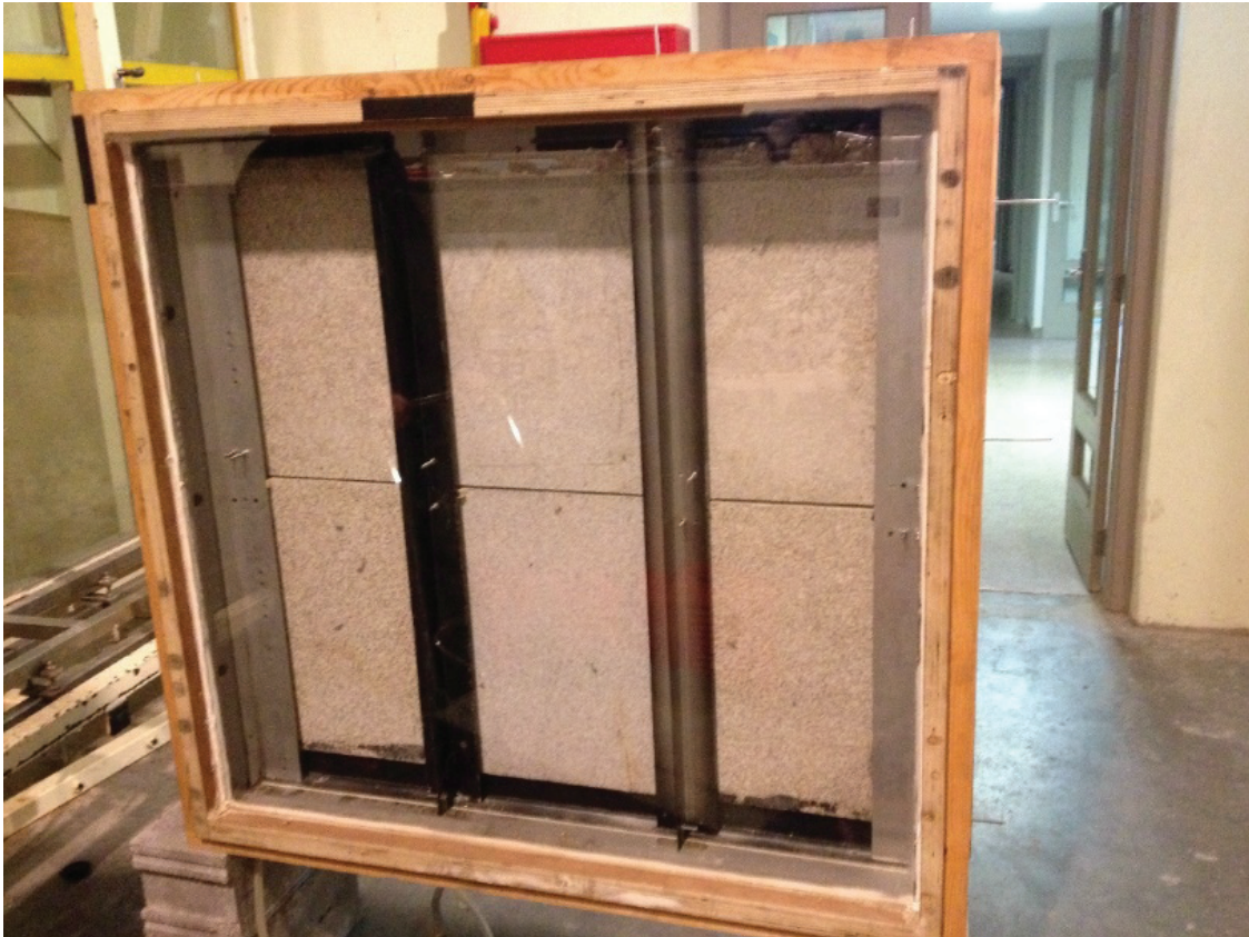
Figura 6.1-2. Cara interior de la fachada con juntas horizontales y verticales vista desde la cámara de aire.
