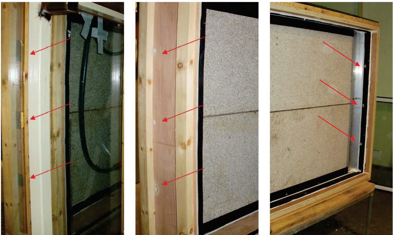
Figura 3.3-6. Orificios de ventilación de la cámara: a) tapados vistos desde fuera; b) sin tapar vistos desde fuera; c) sin tapar vistos desde dentro.
