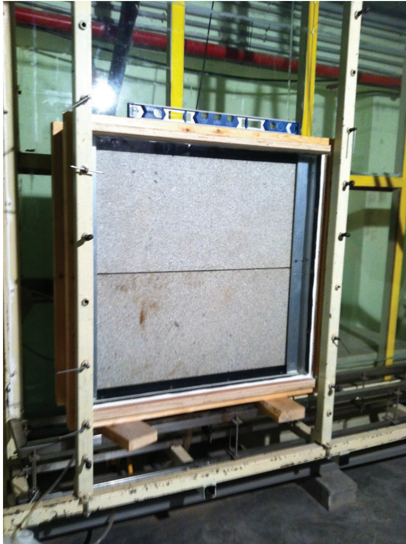
Figura 3.3-8. Vista interior de la fachada con junta horizontal desde la cámara de aire.
