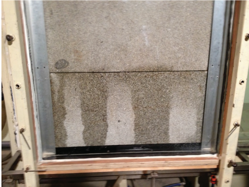
Figura 4.2-3. Fase 3: aumenta la infiltración de agua.
