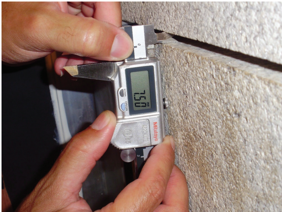
Figura 3.3-4. Calibrado de amplitud de junta.
