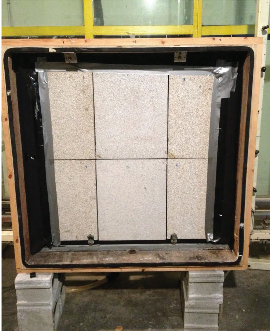
Figura 6.1-1. Cara expuesta de la fachada con juntas horizontales y verticales.
