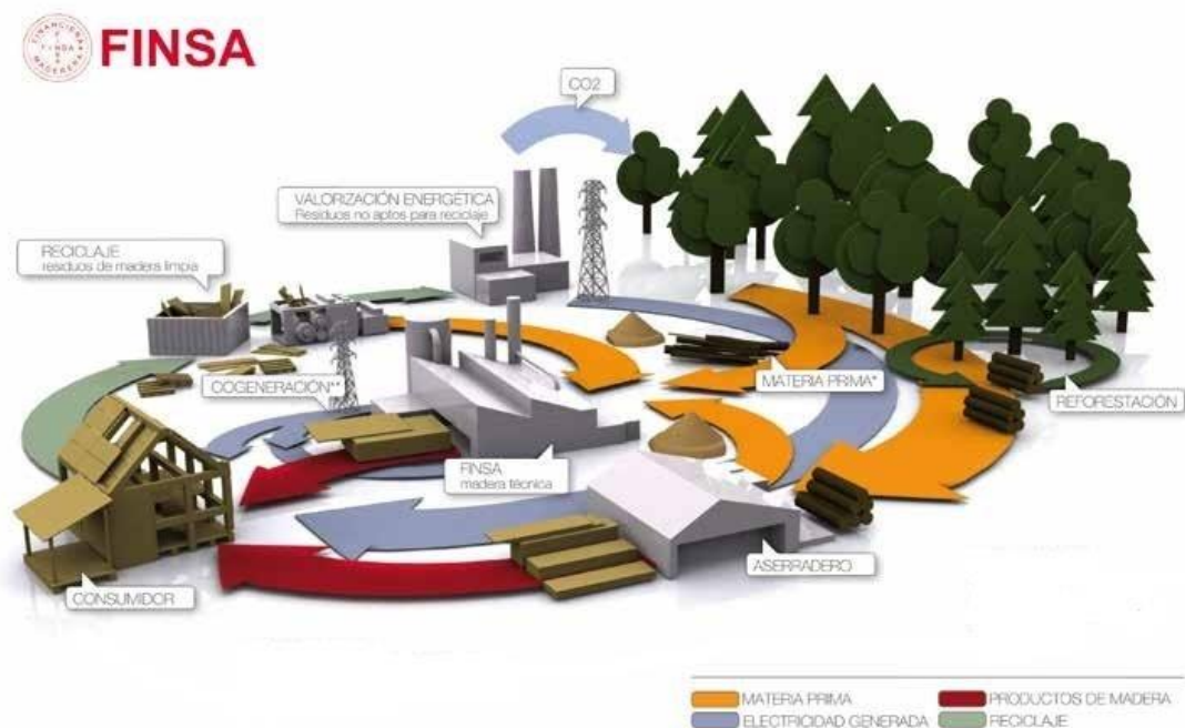
Ilustración 1: Circuito productivo de los materiales derivados de la madera en Finsa
