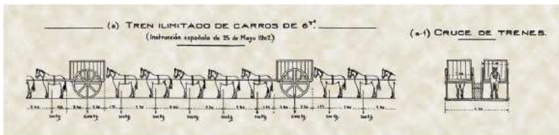
Tren de cargas original del puente 351 .
