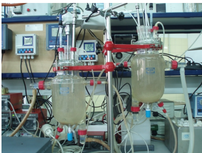
Figura 2.18 Reactores Sharon durante la puesta en marcha, operando con agua sintética.
