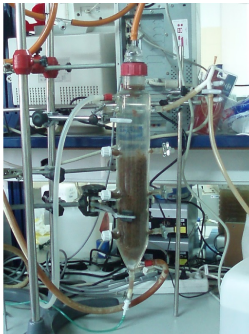
Figura 2.20 Cultivo de bacterias Anammox en un reactor UASB.
