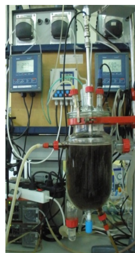
Figura 2.19 Reactor Sharon alimentado con lixiviado diluido 1/5 y pretratado anaeróbicamente.
