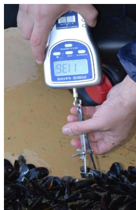
Figura 6. Método de obtención de valores de fuerza de fijación.
