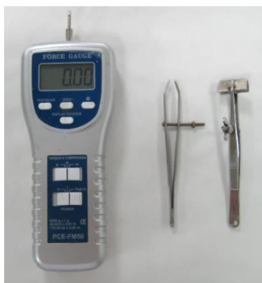
Figura 5. Aparato medidor de fuerza de fijación (Dinamómetro).
