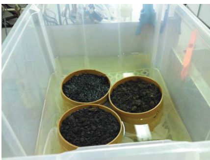
Figura 2-5. Saturación con auga das mostras de compost na etapa de pretratamento
