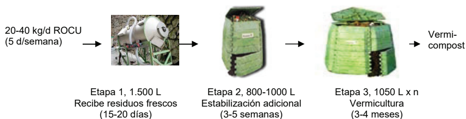
Figura 9-9. Esquema do proceso de compostaxe na ETSA. Na Etapa 2 o composteiro pódese substituír por unha bolsa transpirable.
