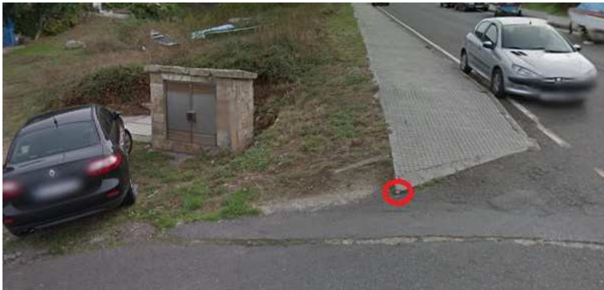
Figura 2: Base de replanteo 1
