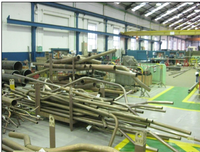
Ilustración 71. Área de almacenaje de tubos a la espera de ser transportados para su montaje
