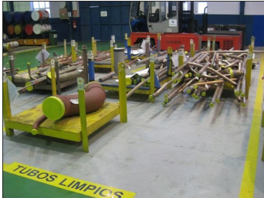
Ilustración 75. Área de almacenaje de tubos disponibles para montaje
