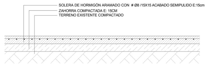
DETALLE Hr. SOLERA DE HORMIGÓN PARA PAVIMENTOS RODADOS e:1 / 20
