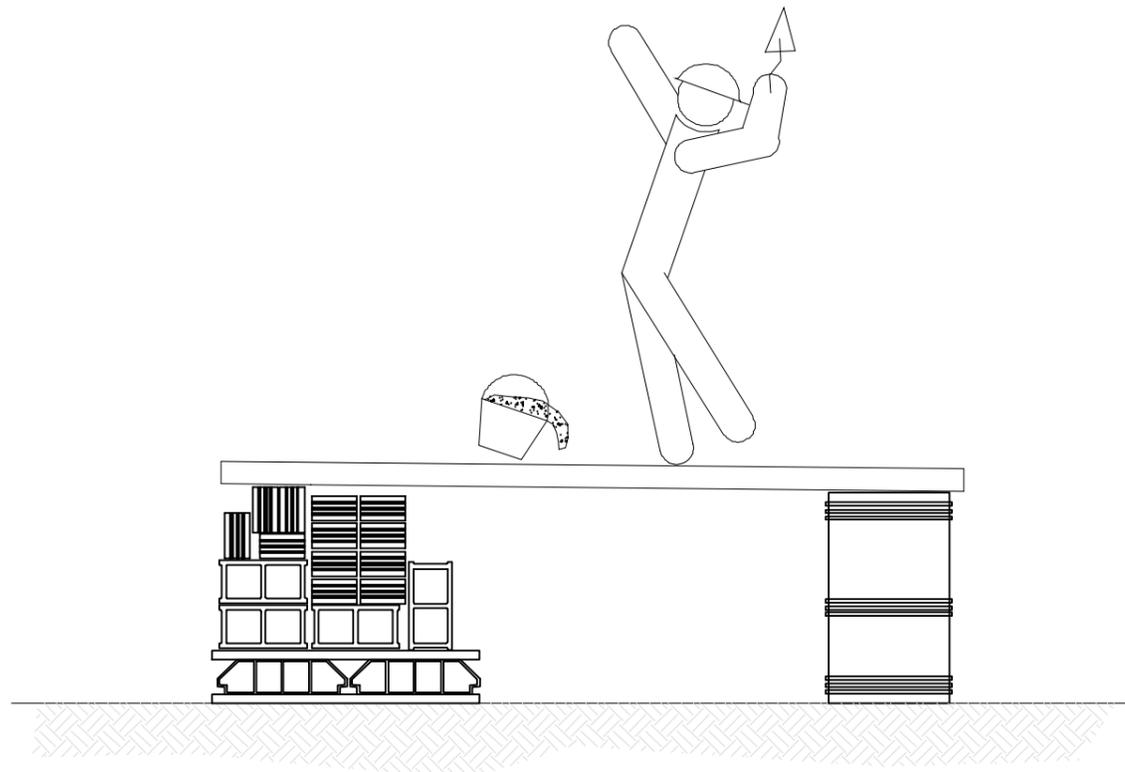
NO UTILIZAR PARA EL APOYO DE LOS TABLONES, OTRO ELEMENTO DISTINTO DE LAS BORRIQUETAS.
