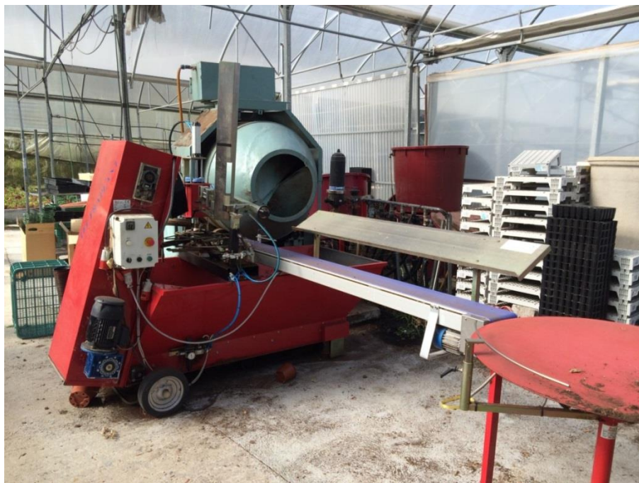
Figura 35. Máquina para llenado y plantación de macetas
