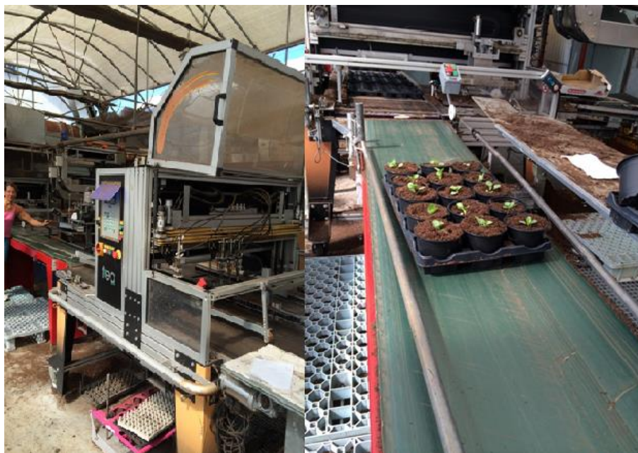
Figura 44. Máquina con pinzas para plantío automático y macetas recién trasplantadas en cinta transportadora
