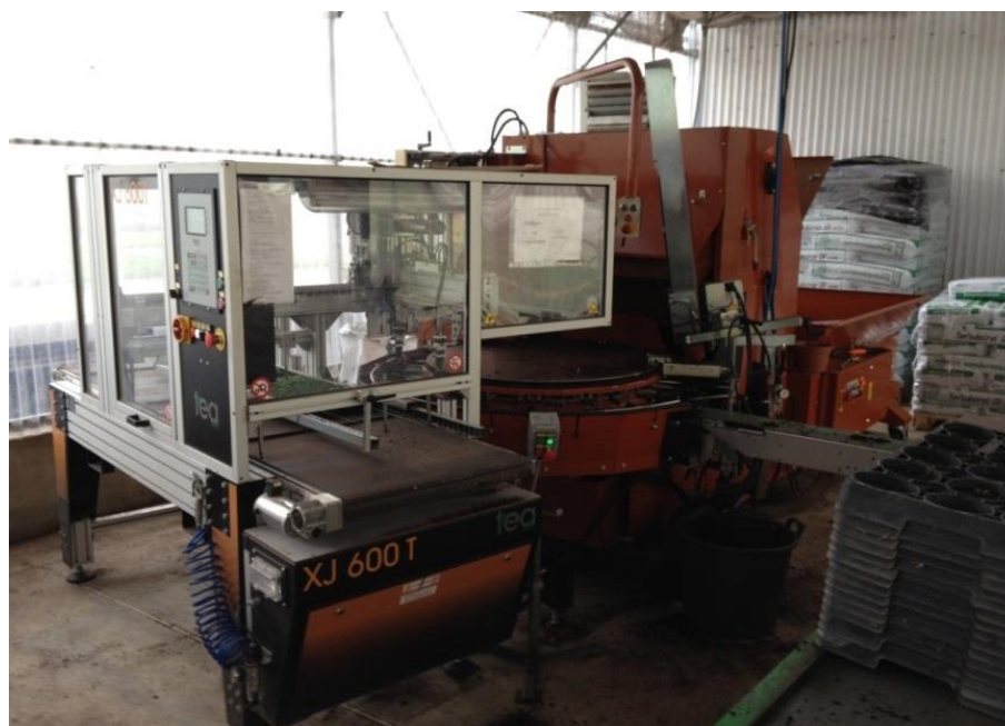
Figura 73. Máquina de plantación y llenado de macetas
