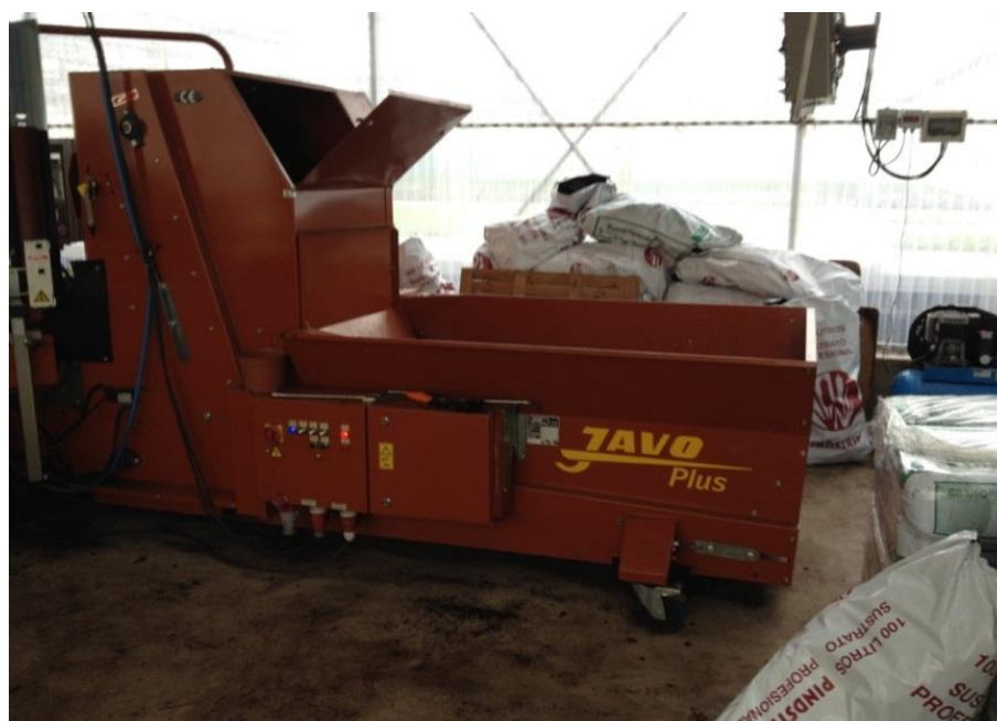
Figura 74. Mezcladora de Sustratos
