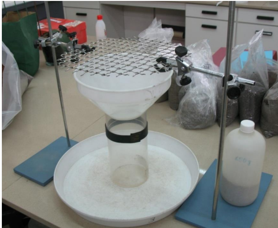
Figura 7. Cilindro de ensayo, collar, controlador de caída y pistón
