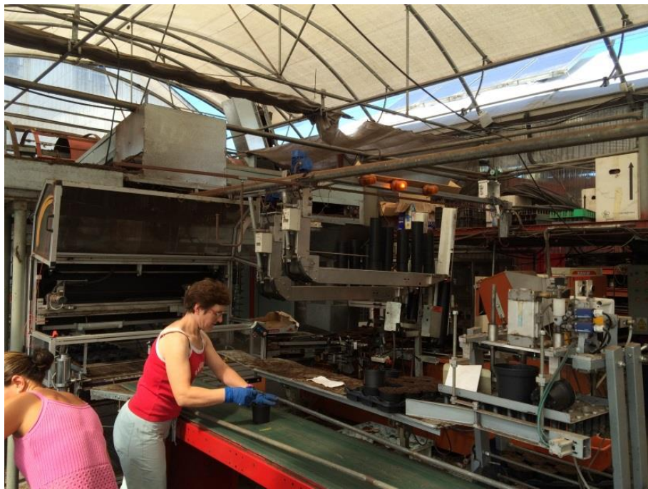
Figura 43. Línea de relleno de macetas con sustrato y plantación
