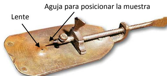
Figura 2-Microscopio de una sola lente de Leeuwenhoek
