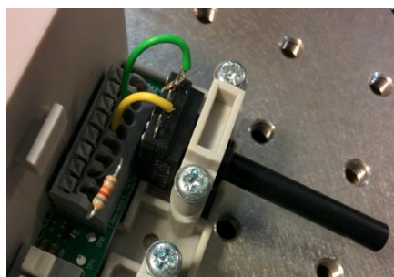
Figura 27-Instalación del potenciómetro
