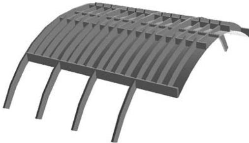
Figura 5 Modelo tridimensional de la estructura de hormigón armado de la cubierta del gimnasio.
