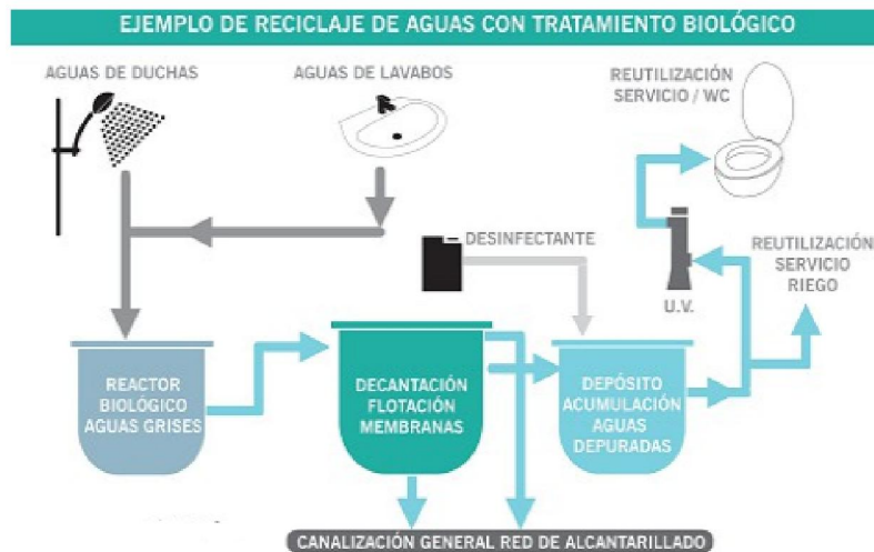
Imagen 2.12 Esquema de un ejemplo de tratamiento biológico de aguas grises (AQUA 2011b)
