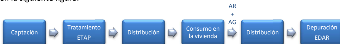
Figura 3.1 Ciclo integral del agua en la vivienda
