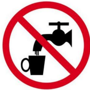
Imagen 2.16 Identificación de los puntos de suministro de AG o pluviales. Las tuberías que no suministren agua potable también deben ir marcadas
