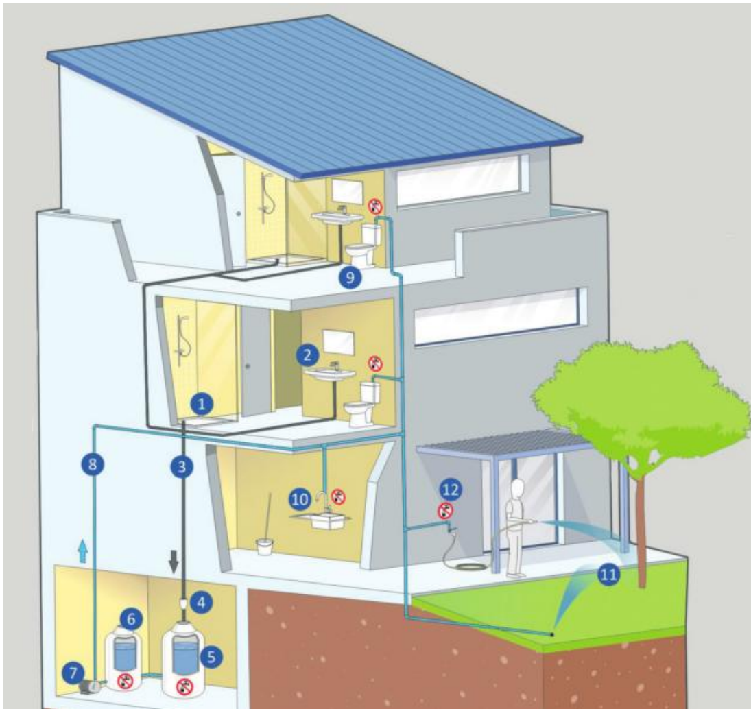
Imagen 2.9 Esquema de un sistema centralizado de aguas grises (AQUA 2011b)
