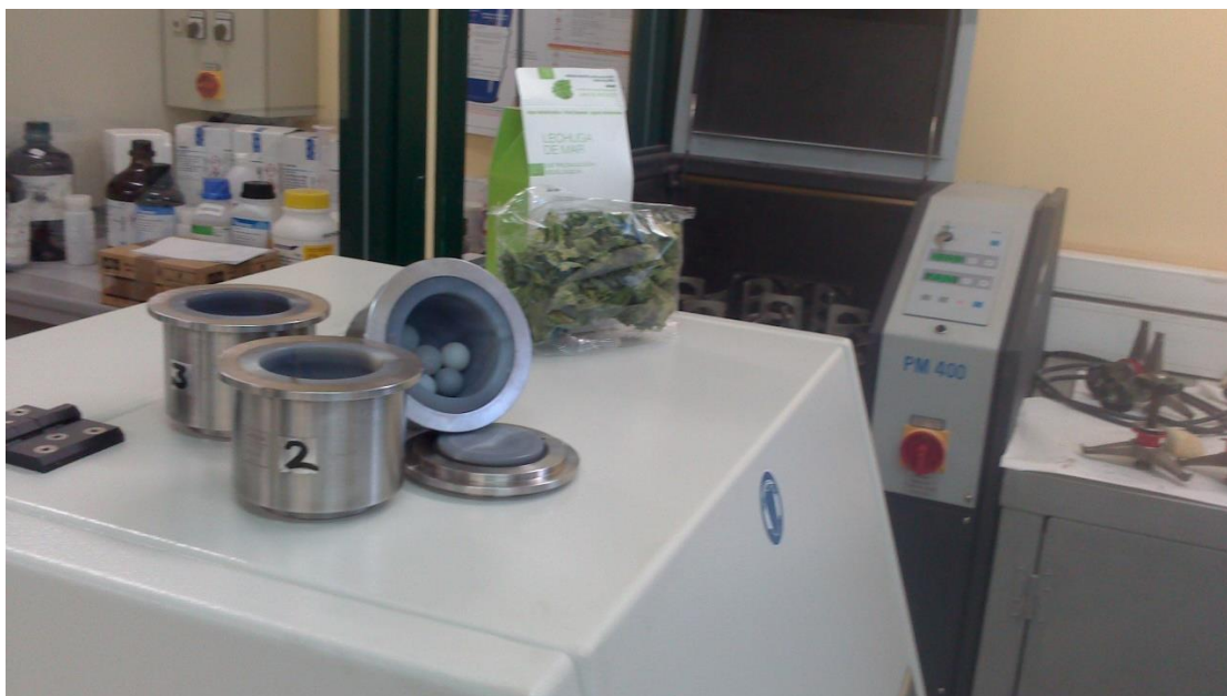
Figura 5: Cilindros con bolas de circonio y muestra de alga a estudiar
