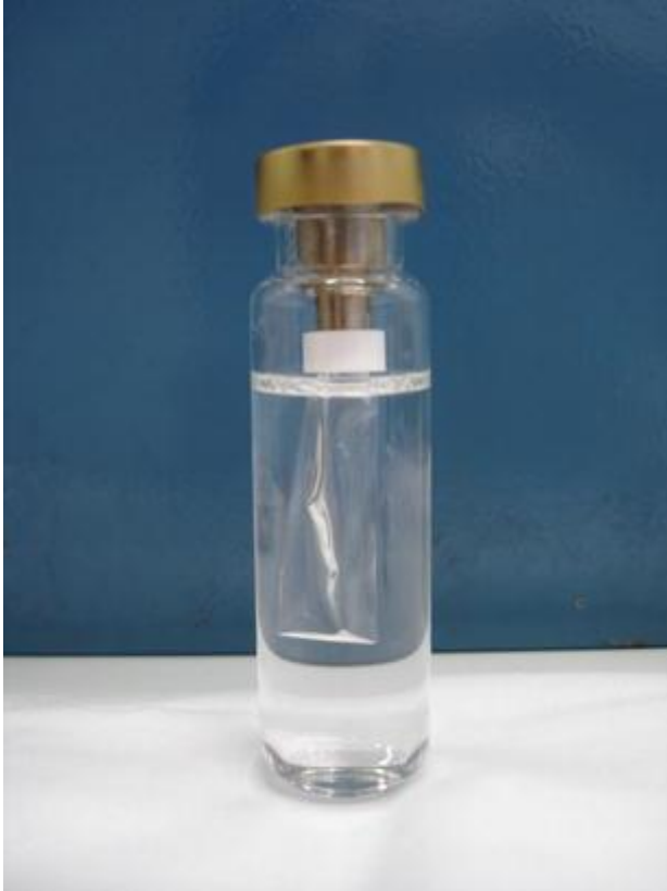
Figura 2: Sistema de extracción asistida por membrana
