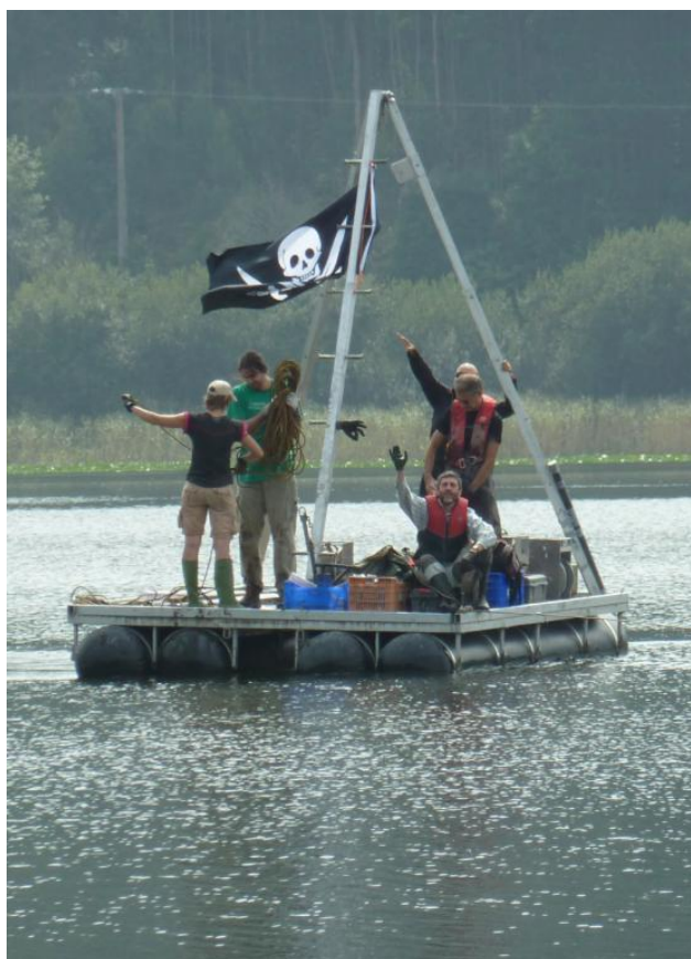
Figura 2: Plataforma flotante UWITEC en el lago de Doniños utilizada para la extracción del testigo
