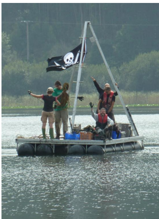
Figura 2: Plataforma flotante UWITEC en el lago de Doniños utilizada para la extracción del testigo
