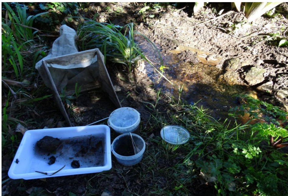
Figura 2. Material utilizado para el muestreo: red tipo Surber, botes de plástico con tapas, bandejas de plástico y pinzas.
