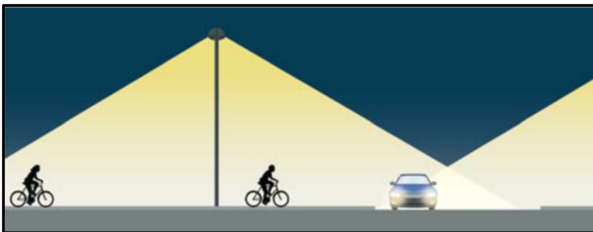
Imagen 29: Alumbrado público sobre carril bici en intersecciones;
