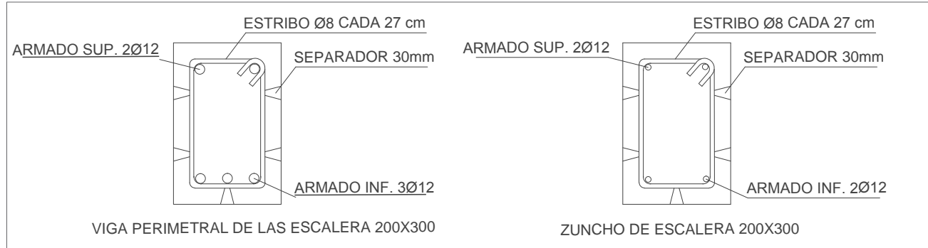
DETALLE DE VIGA Y ZUNCHO DE LA ESCALERA
