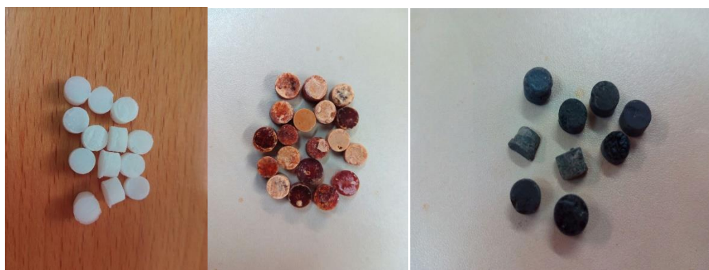
Figura 6: A la izquierda se muestran las pastillas de silicato+ludox en el centro las de silicato+ludox recubiertas de Fe 2+ y a la derecha las de silicato+ludox recubiertas de Fe reducido.
